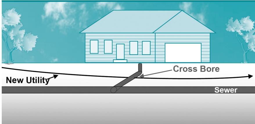
A veces, la tubería de gas que sirve a una casa se instala accidentalmente de modo que cruza la tubería de alcantarillado. Esto se denomina perforación cruzada, que puede ocurrir cuando se usa tecnología sin zanjas para instalar tuberías de gas o cuando las líneas de alcantarillado no se mapearon o instalaron con tecnología localizable.
